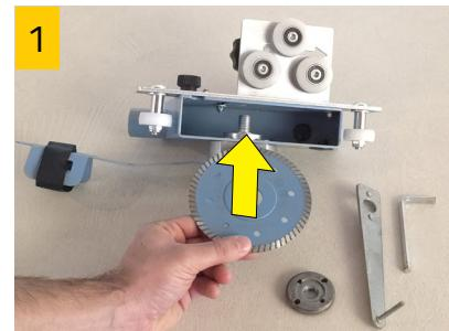
Inserire il disco e montarlo, controllando che giri senza oscillare.
