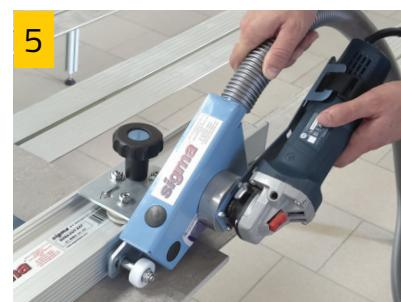
Inserire il tubo per l'aspirazione delle polveri e segnare la piastrella da ambo i lati per la misura di taglio.
