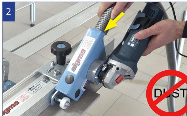
2 Inserire il tubo d'aspirazione per la totale rimozione delle polveri.
