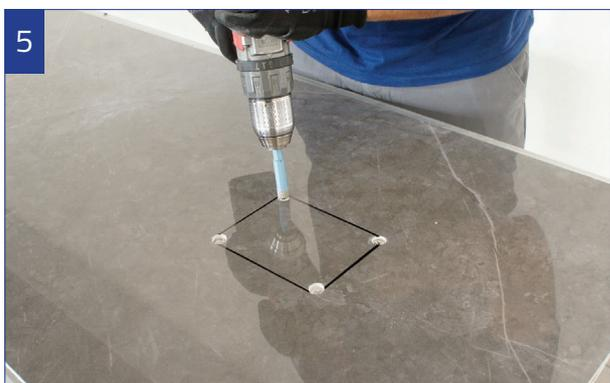
Per l'esecuzione di fori rettangolari o tasche è importante realizzare quattro fori (ø minimo 8mm) in ciascun angolo per evitare eccessive tensioni.
