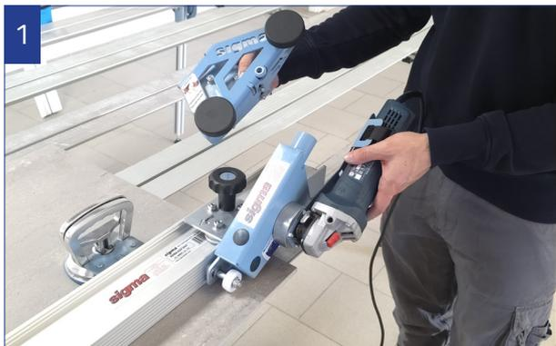
1 Posizionare la guida KERA-CUT sulla lastra, togliere il carrello scorriore e sostituirlo con il KERA-FLEX.
