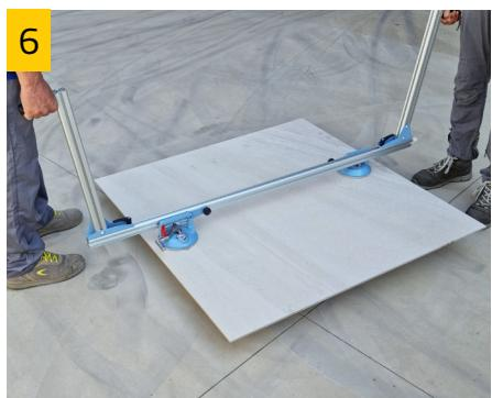
■ Alzare il telaio mantenendo eretta la schiena e sollevando con la forza delle gambe.
