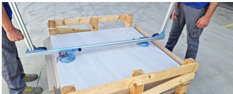
■ Quando si sollevano le piastrelle da posizioni rialzate è possibile abbassare le maniglie per un confort ottimale.
