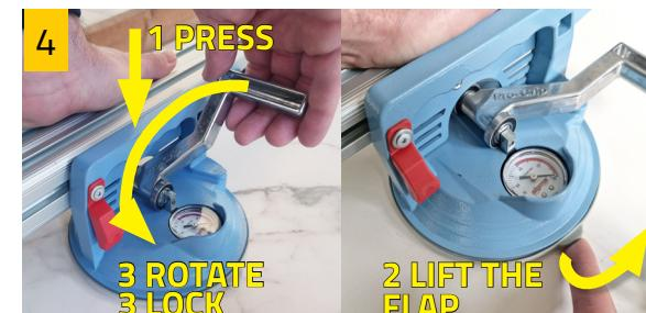
Posizionare il telaio sulla piastrella precedentemente pulita e asciutta in posizione centrale.
