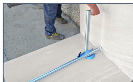
Le maniglie rialzate possono essere spostate per rimanere nell'ingombro della piastrella. The raised handles can be moved to remain within the tile footprint.
