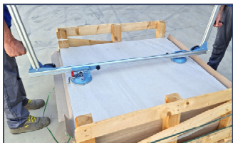
Durante l'estrazione dalla cassa le maniglie possono essere spostate per il massimo confort. When removing from the box the handles can be moved for maximum comfort.
